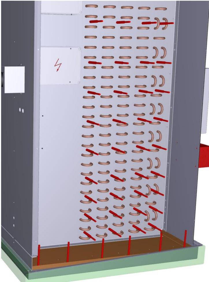
Abbildung 4: Elektro-Heizstäbe (**rote Markierung**)
