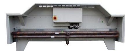
(X-)TCH: Verflüssiger Kupferrohr, für Kältemittel der Gruppe A1, Rohrteilung versetzt, Rohr 9,52mm oder 12,0mm,
