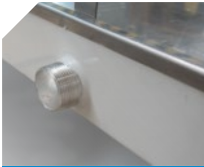
horizontaler Kondenswasserablauf/ horizontal condensate drain
