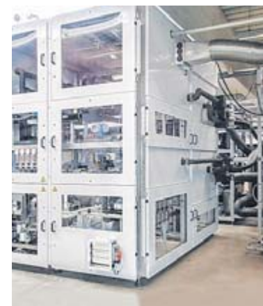
Prüfstand im Werk Heinsdorfergrund. Dort werden Wärmetauscher sogar im Luftkanal getestet.
