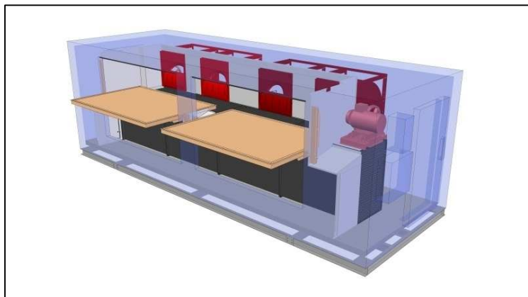
Die alte Generation: Isolierkühler mit über Keilriemen angetriebenen Radialventilatoren
